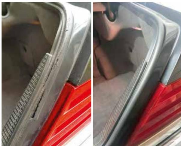
Vergleich: alte und neue Heckdeckeldichtung
