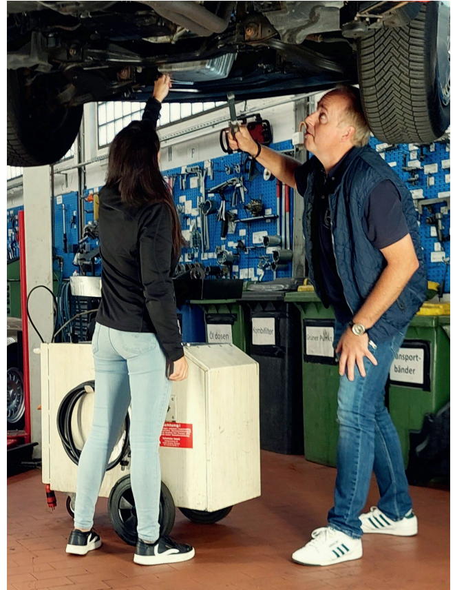
1. Arbeitsschritt: Öl ablassen
