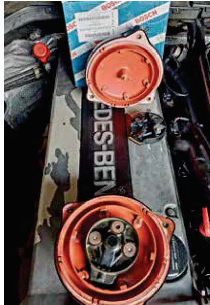
Corpus Delicti: oxidierte Kontakte in der Verteilerkappe waren nach der langen Standzeit der Grund für den unruhenden Motorlauf. (vorne das Alt- und hinten das Neuteil) Arrest
